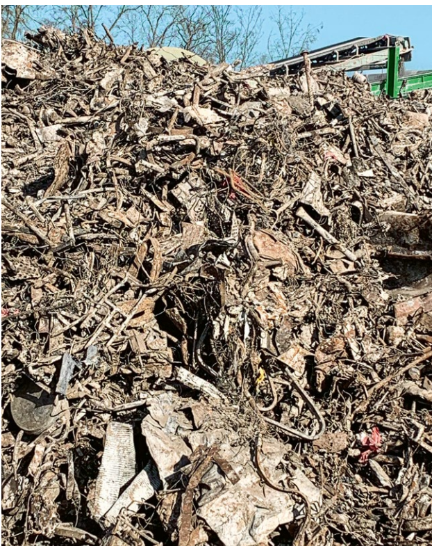
Bei der ersten Sortierung werden die grossen Teile aus Eisen herausgefiltert.
